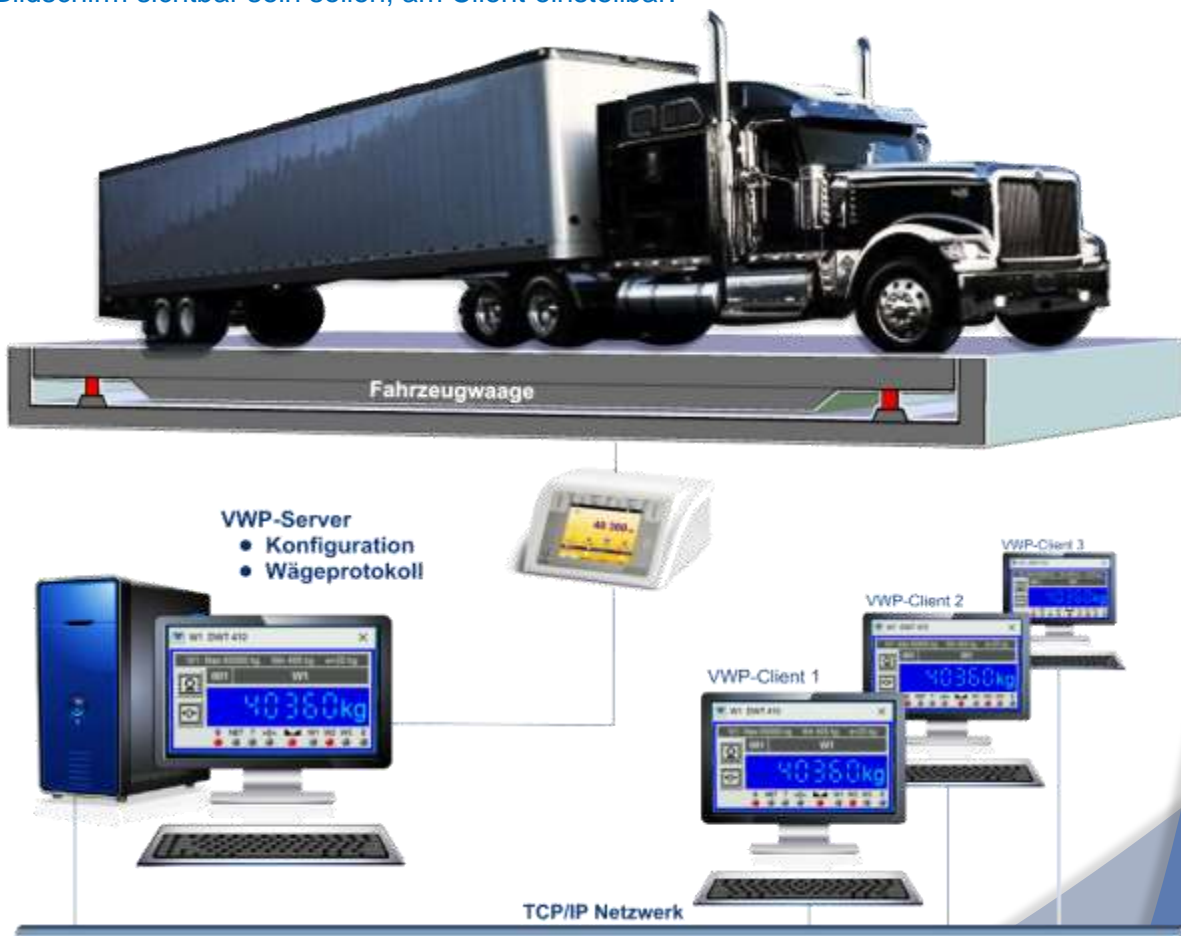
Blockschema einer Server/Client-Installation
